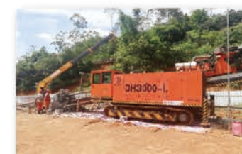
DH3000-L型水平定向钻机江西施工现场
