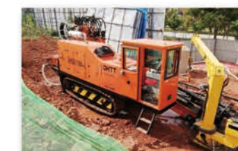
DH500/1000-L型水平定向钻机南京施工现场
